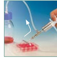
Aspiration avec soupape inversée
